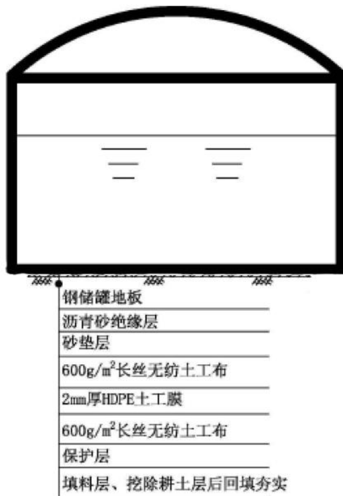
图7.2-2 储罐基础防渗结构示意图
