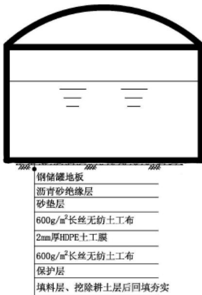
图7.2-2 储罐基础防渗结构示意图
